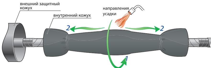
**5.1** Надвинуть на муфту внутренний кожух длиной 700 мм и расположить его симметрично относительно центра муфты;
